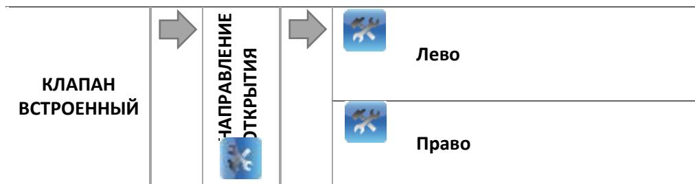
Если при подключении клапана к контроллеру, окажется, что он должен быть подключен наоборот, это не нужно исправлять путем переключения проводов питания, т.к. есть возможность изменения направления открывания клапана, путем выделения в выбранном направлении: Право или Лево.
