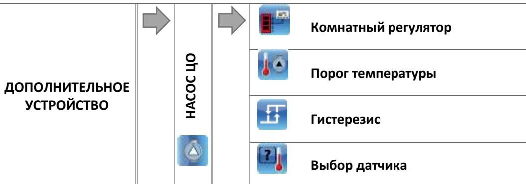
При выборе этой опции дополнительный насос будет выполнять функцию дополнительного насоса ЦО. этот Насос будет включен, если температура на датчике превысит пороговое значение температуры.
