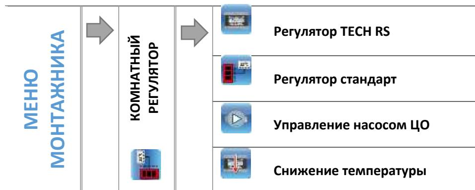
Эта функция используется установки параметров работы комнатного регулятора, подключенного к контроллеру котла. Для того, чтобы совместная работа с комнатным регулятором была активна, необходимо при подключении активировать ее, выбрав соответствующий тип регулятора. К контроллеру можно подключить до двух комнатных регуляторов.
