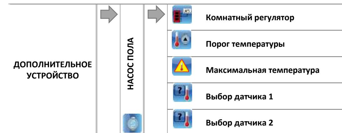
При выборе этой опции дополнительное устройство будет выполнять функцию напольного насоса - служащего для управления системой напольного отопления.
