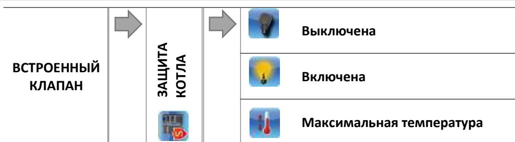
Защита от слишком высокой температуры ЦО, чтобы избежать опасного повышения температуры котла. Пользователь устанавливает максимальную допустимую температуру котла.
