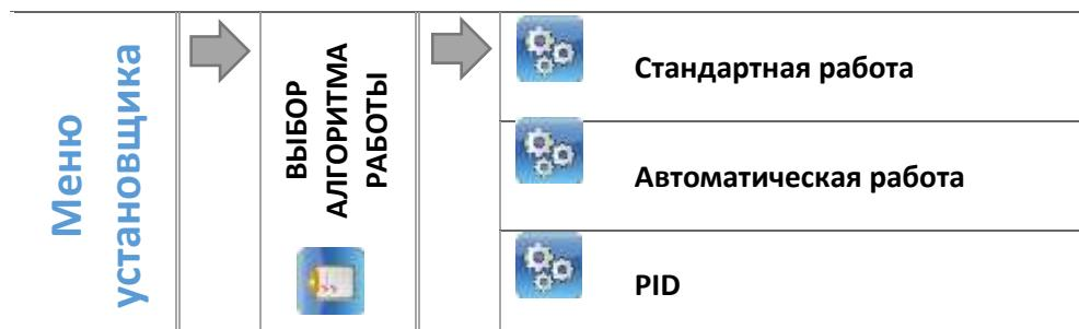
Эта функция используется для выбора алгоритма работы контроллера. В зависимости от заданного алгоритма работы, изменяются последовательные фазы работы котла.
