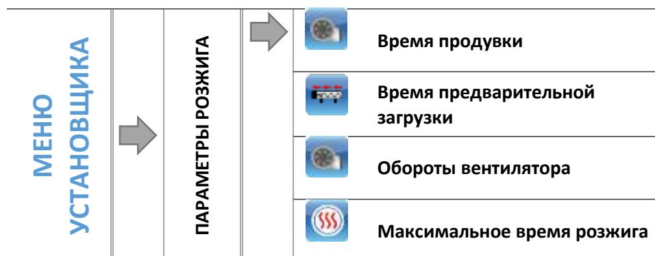
Параметры розжига относятся к детальной настройке процесса розжига. Вы должны настроить параметры для используемого типа топлива.
