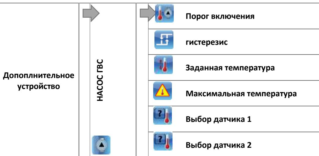
При выборе этой опции дополнительный насос будет выполнять функцию насоса ГВС. Этот насос будет включаться при превышении температуры порогового на выбранном датчике 1 и будет работать до момента достижения заданной температуры на датчике 2. Кроме того, при помощи этой функции Вы можете установить сигнализации температуру на датчике 1, достижение которой приводит к запуску процедуры отказа.
