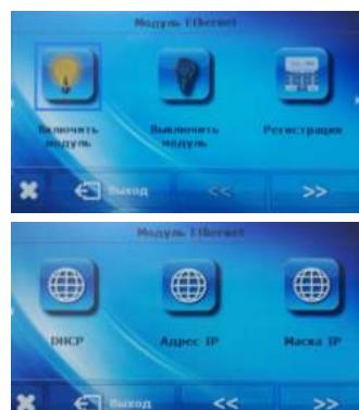
Процесс установки и обслуживания интуитивно понятен. После правильного подсоединения модуля в меню специалиста по установке главного контроллера следует включить Интернет-модуль (**Меню>> Меню специалиста по установке>> Модуль сети Интернет>> Включить**) – после включения опции Регистрация будет сгенерирован регистрационный код, который следует указать на открывшейся странице.
