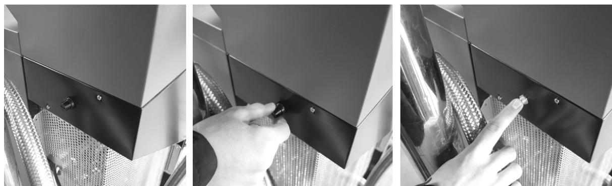
Рис. 17: Включение термического предохранителя
