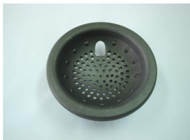
**Это ёмкость для сжигания гранул** (рис. 10). Мы рекомендуем проверять дно камеры сгорания и очищать его от золы при каждой чистке. Устанавливая ёмкость для сгорания обратно на место, убедитесь, что она установлена правильно: её необходимо задвинуть к задней стенке до упора. Только в этом случае Вы можете быть уверены, что котёл будет работать normally.
