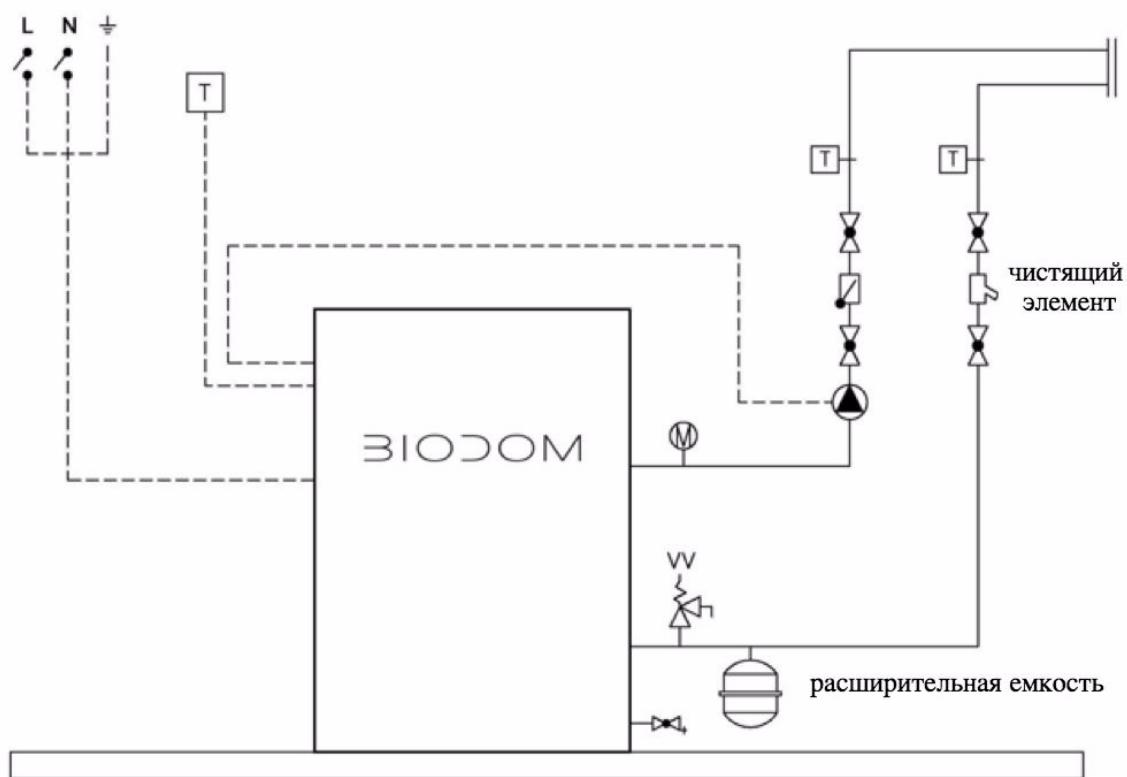
**Схема подключения 1**
