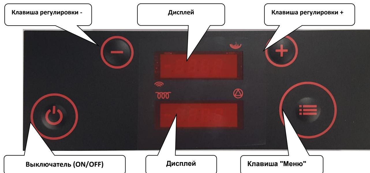
Котёл готов к запуску после того, как монтажник подключит его к системе центрального отопления, к дымоходу при помощи патрубка и к электросети согласно инструкциям по монтажу. После того, как все пункты, указанные в инструкции для монтажника, будут проверены, отопительный прибор Biodom 27 можно запускать нажатием кнопки ON/OFF (см. **рис. 18**). Это должен делать монтажник, устанавливавший устройство.
