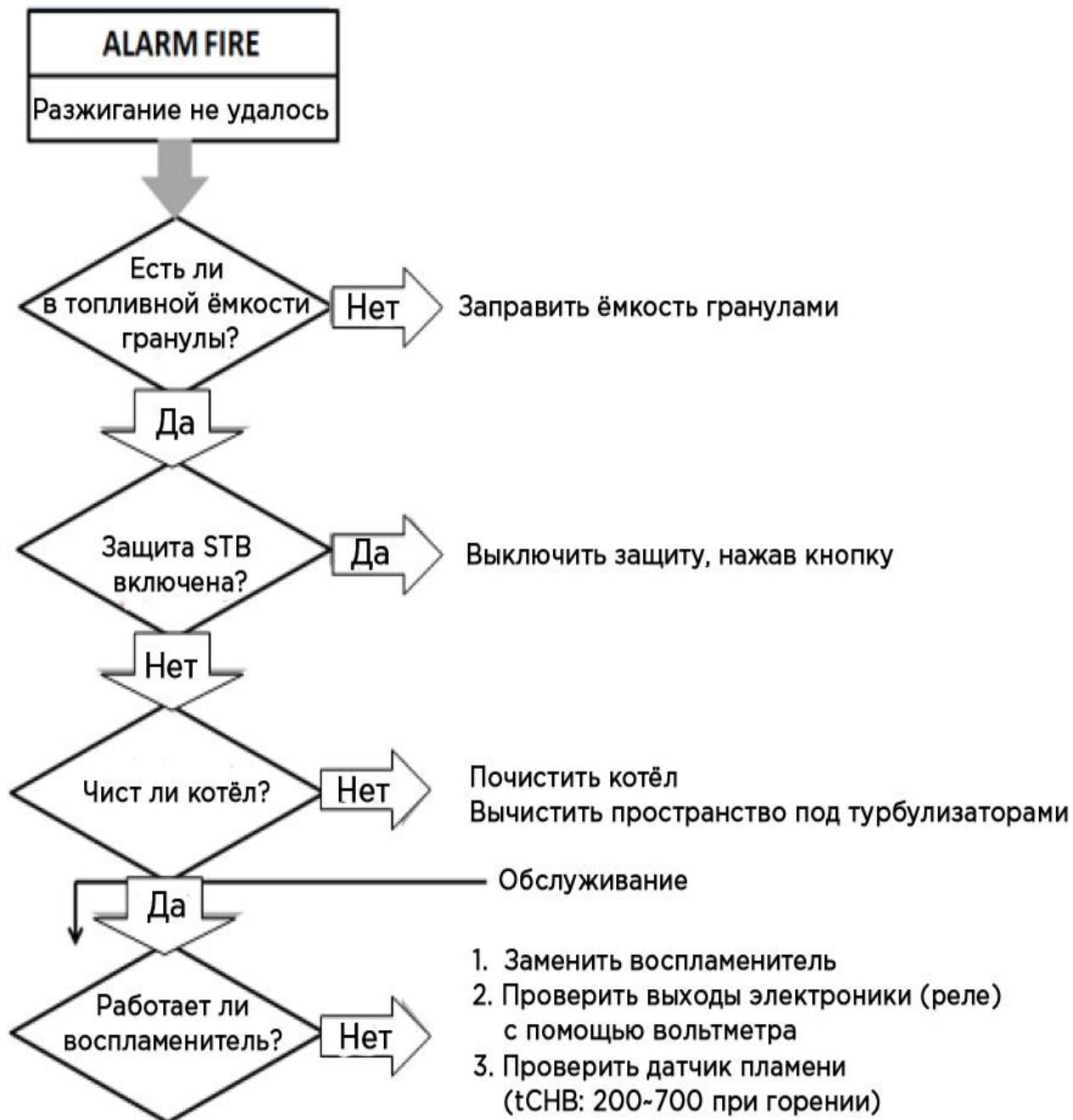
Дополнительно: проверить зависание пеллет над шнеком или в канале подачи пеллет в камеру сгорания.
