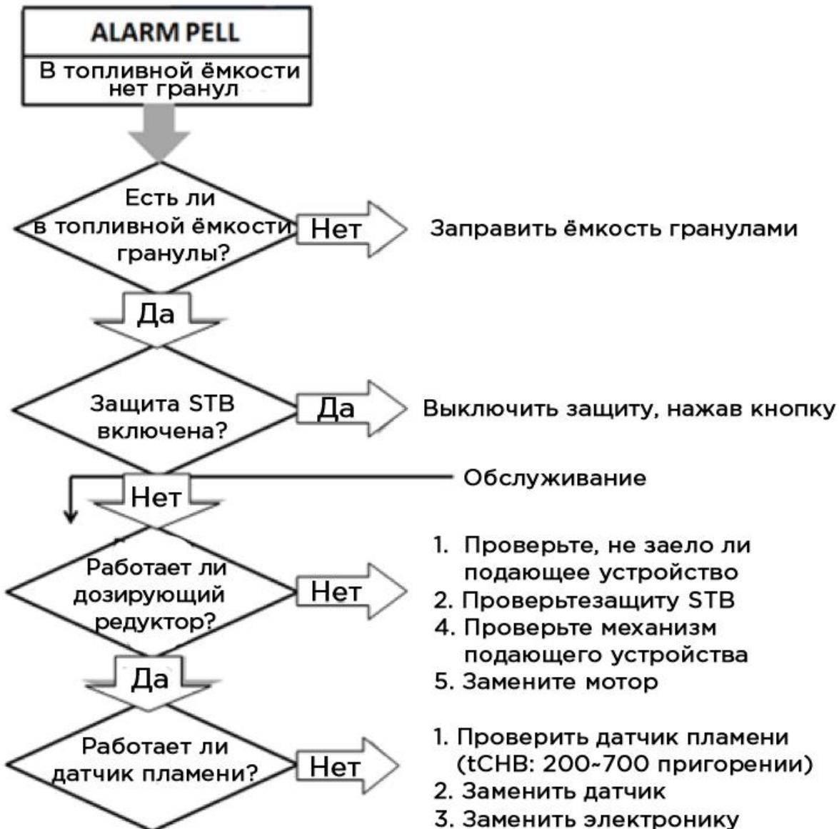
Дополнительно: проверить зависание пеллет над шнеком или в канале подачи пеллет в камеру сгорания.
