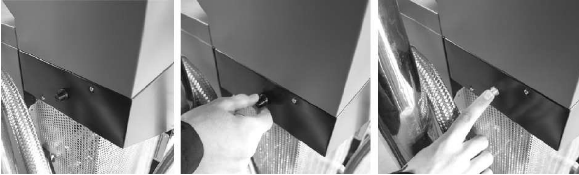
Рисунок 18. Включение термического предохранителя STB.
