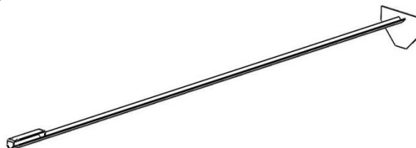
поз. 4 –Очиститель котла
