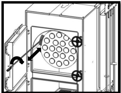
Очистить радиусные поверхности теплообменника при помощи «Очистителя теплообменника» (рис. 21).
