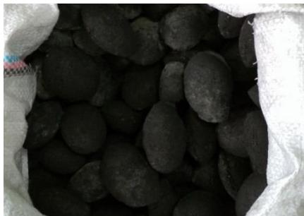
**Угольные брикеты** – порционное топливо, которое изготавливается путём прессования и последующего обжига мельчайших фракций угля (стружки, пыли).
