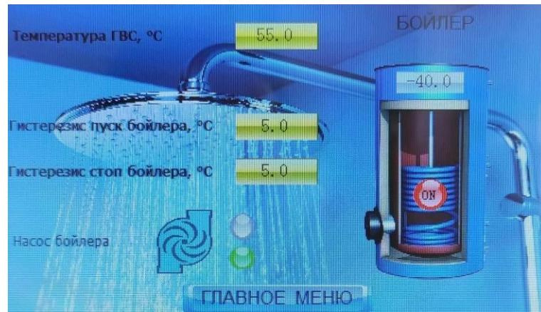
Экран управляет насосом бойлера. Позволяет задать температуру запуска насоса бойлера и температуру остановки насоса бойлера.
