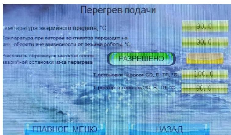
Температура аварийного предела - при ее достижении горелка будет остановлена с предупреждением (см. ниже)
