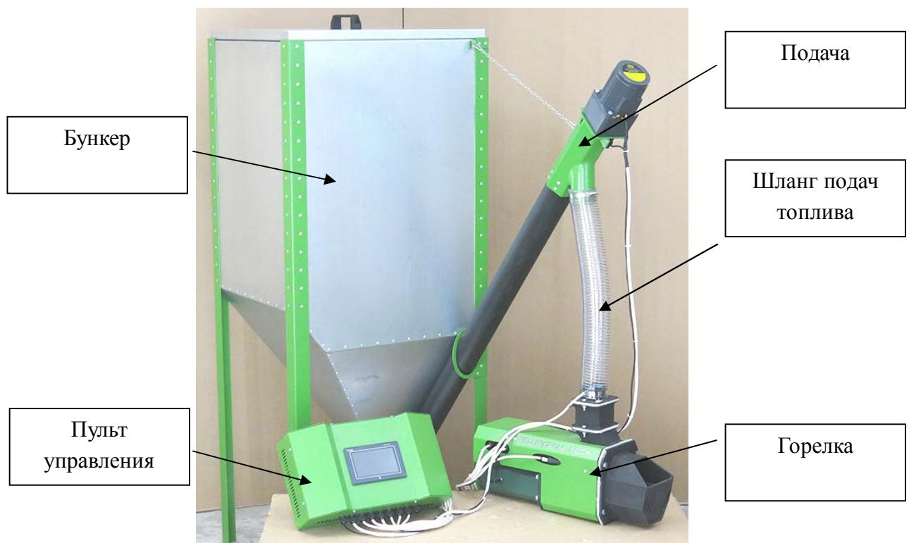
Рис. 5 - Горелка в сборе с бункером
