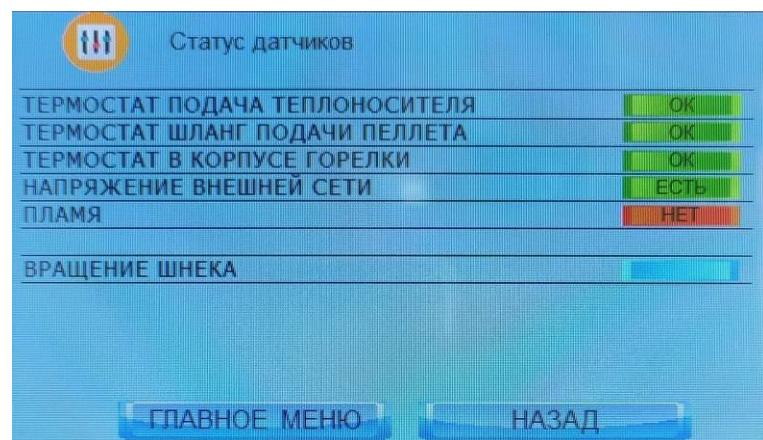
Это сервисный экран. Используется для диагностики датчиков, показывает статус датчиков (замкнут/разомкнут, да/нет, есть сигнал/нет сигнала). Например Вращение шнека мигает при прохождении шторки через оптическую ось датчика вращения.
