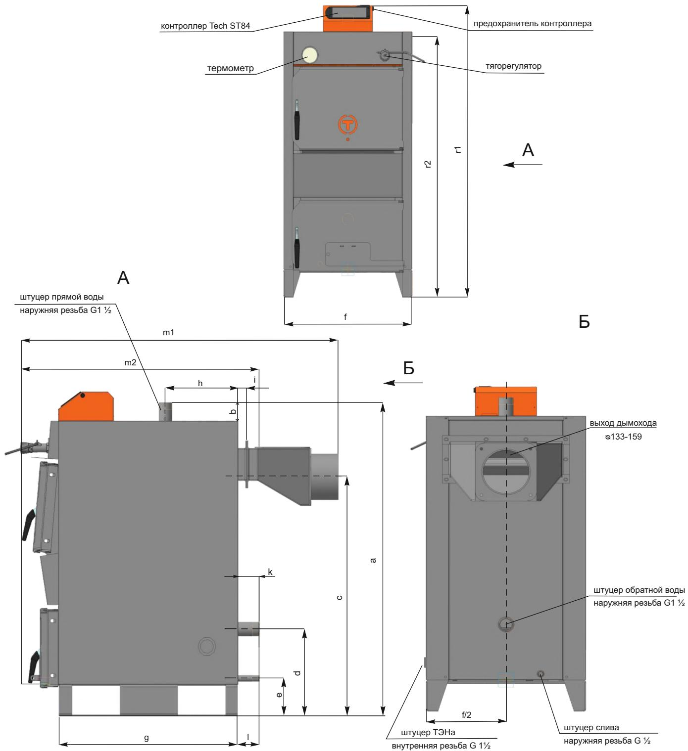
Рисунок 2. Габаритные и присоединительные размеры котлов «ТЕПЛОВЪ» серий «Smart» и «Smart Auto» моделей S10÷30
