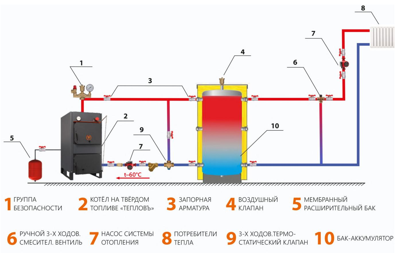
Рисунок 4. Типовая схема обвязки котла «ТЕПЛОВЪ» с баком- аккумулятором
