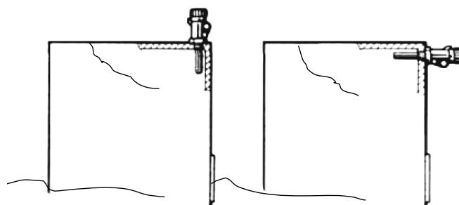
Рисунок 9. Схема размещения тягогрегулятора на корпусе Котла
