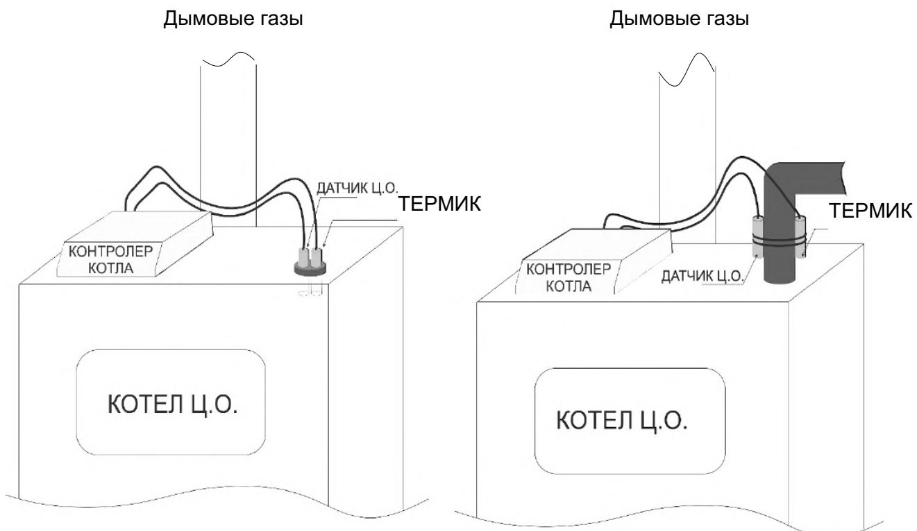
Рисунок А.2 – Схема размещения термика
