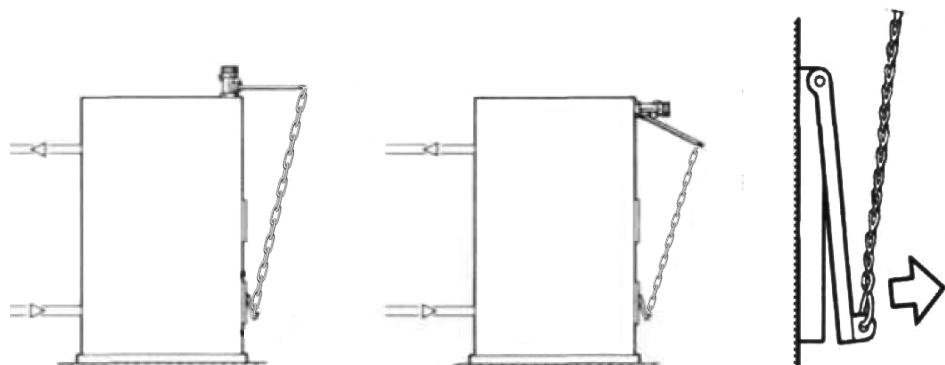
Рисунок 10. Схема закрепления цепи тягогрегулятора на заслонке нижней дверцы котла
