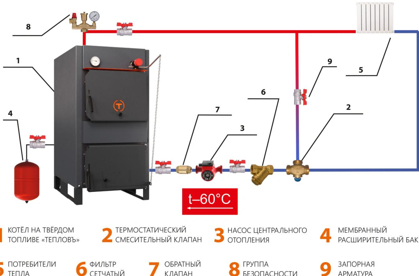
Рисунок 5. Типовая схема обвязки котла «ТЕПЛОВЪ» с 3-х ходовым клапаном
