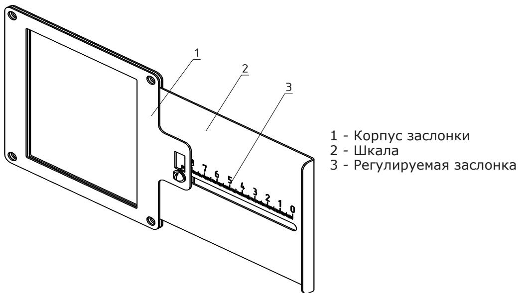
**Рис.12 Заслонка вентилятора**
